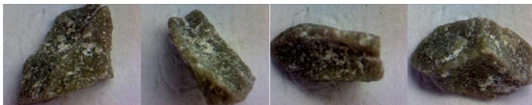
图 C.0.4-1 机制砂颗粒不同方向上的照片
