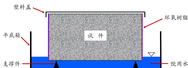
图 B.0.5 毛细吸水速率测试装置
