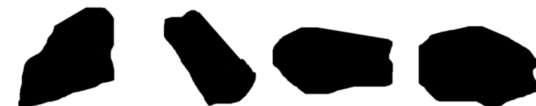
图 C.0.4-2 二值化处理后的机制砂投影黑白图像
